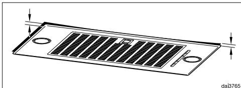
Ukoliko je površina za ugradnju neravna te je time otežana ugradnja u ravnni površine, okvir se može naknadno posetiti.
