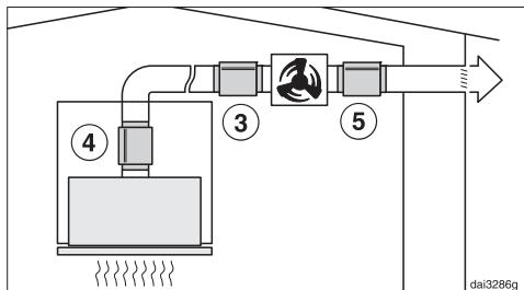
Za minimaliziranje šumova ventilatora u kuhinji prigušivač buke po mogućnosti treba pozicionirati ispred vanjskog ventilatora (3), a kod dulje odvodne cijevi na ispušni nastavak na napi. Kod vanjskog ventilatora koji je postavljen u kući pomoću prigušivača buke iza vanjskog ventilatora (4) mogu se smanjiti šumovi ventilatora prema van.
