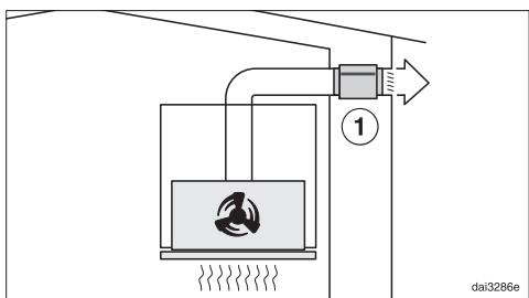
Prigušivač buke prigušuje šumove ventilatora prema van, ali i vanjske šumove koji kroz odvodnu cijev prodiru u kuhinju (npr. ulična buka). Zato se prigušivač buke pozicionira što je moguće bliže izlazu odlaznog zraka (1).
